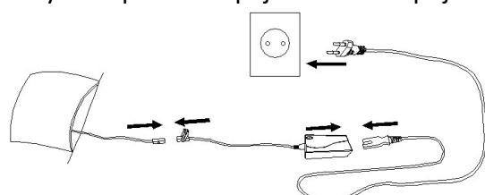
Uistite sa, že informácie o elektrickom pripojení uvedené na typovom štítku sú v súlade s parametrami napájacieho systému. V opačnom prípade kontaktujte elektrikára.
